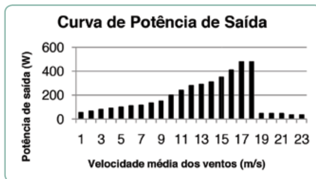
Figura 4 - Curva de potência da turbina IstaBreeze 500 W de acordo com a velocidade dos ventos. Fonte: [12].
