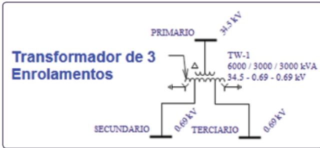
Figura 3 - Unifilar do transformador de três enrolamentos.
