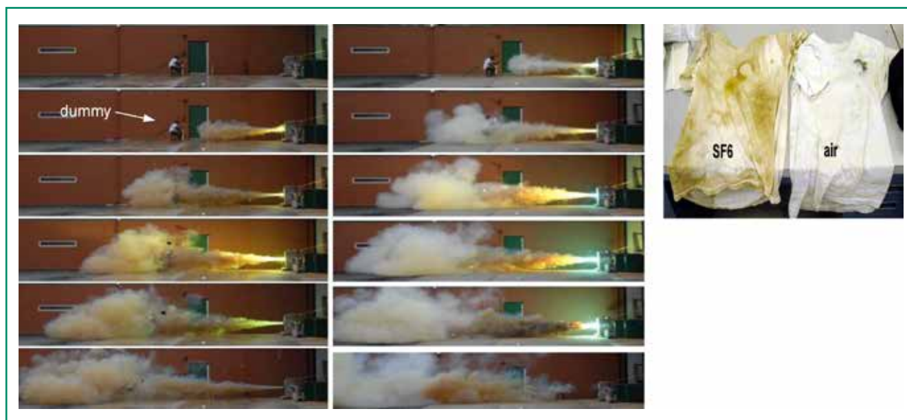
Figura 2 – Fotografias da liberação de gases quentes a partir de arco elétrico em SF6 (esquerda) e ar (direita).
