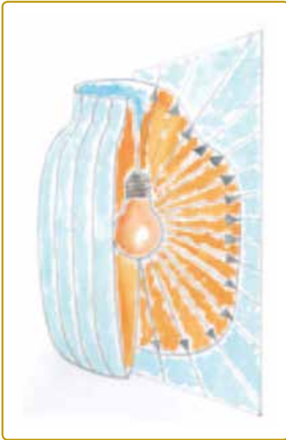
Figura 4 - Ilustração da distribuição da luz gerada por uma lâmpada incandescente.
