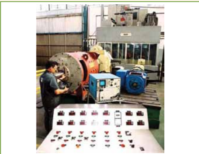
Figura 7 – Serviços de ensaio com carga de motor de indução trifásico “Ex”. Fonte: Eletro Buscarioli
