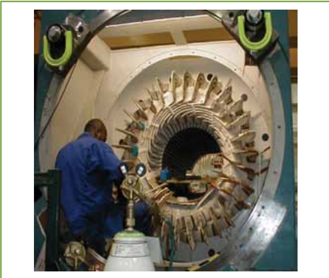
Figura 6 – Execução de serviços de reparos e ensaios elétricos no enrolamento do estator de motor de indução trifásico certificado para atmosferas explosivas, em oficina de reparos com certificação de conformidade. Fonte: IECEX
