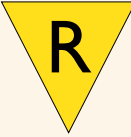
Figura 5 – Marcação de serviços de reparos de equipamentos “Ex”, cujos serviços estão em conformidade com os requisitos das normas técnicas “Ex”, mas não com os documentos da certificação de conformidade.
