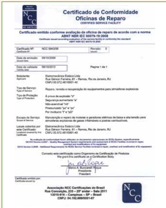
Figura 9 – Certificado de Conformidade de Oficina de serviços de reparos em equipamentos “Ex”, emitido no Brasil, baseado nos requisitos indicados na norma ABNT NBR IEC 60079-19 e nos documentos operacionais IECEx OD 014 e OD 015. Fonte: Eletromecânica Estácio Ltda. / NCC Certificações
