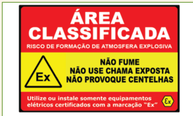
Exemplo de placa de sinalização de segurança para a identificação de áreas classificadas contendo atmosferas explosivas de gases inflamáveis ou de poeiras combustíveis
