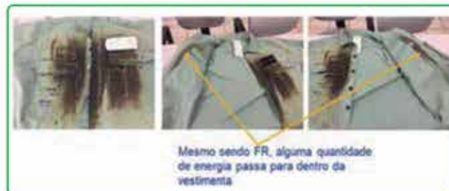
Figura 3 – Vestimenta testada com energia de 9.4 \text{ cal}/\text{cm}^2 indicando que alguma energia passa para o lado interno da vestimenta.
