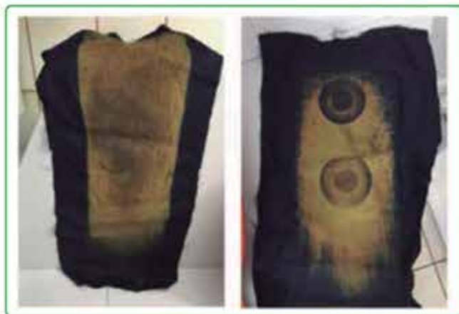
Figura 1 – Ensaio com a quantidade de calor aplicado de um lado do tecido e o sensor colocado no outro lado.
