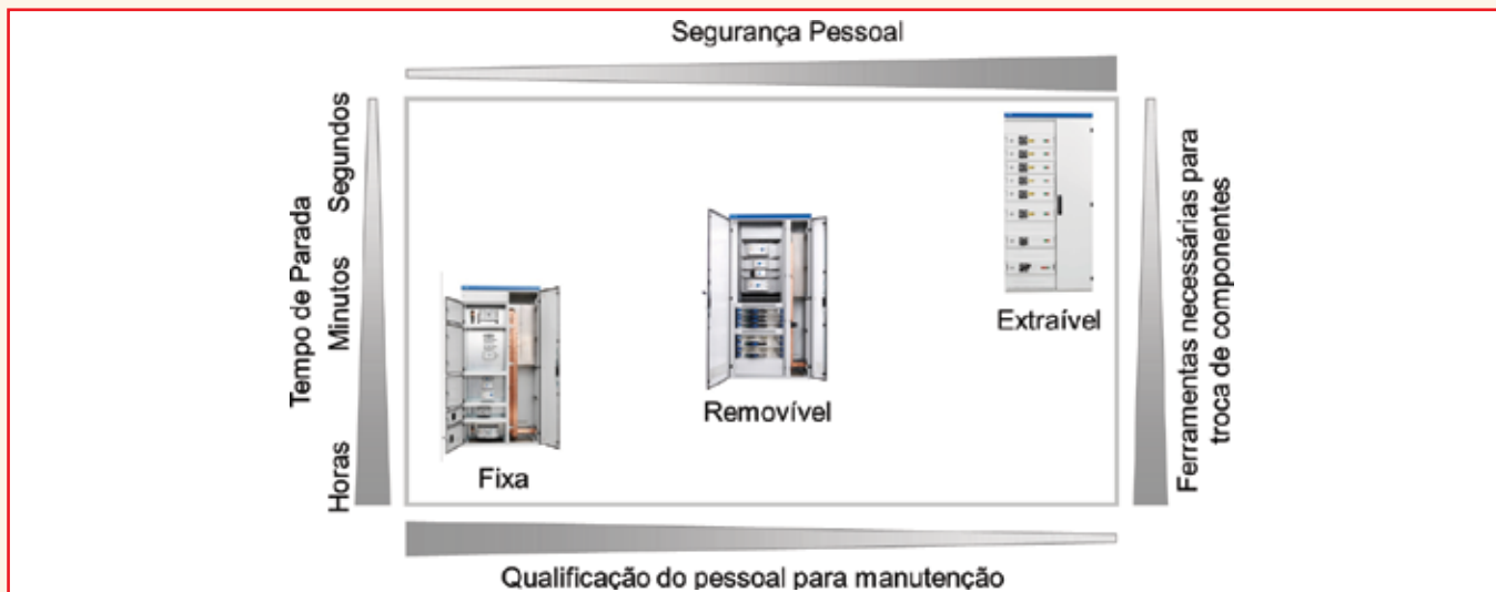
Figura 10 – Comparativo dos requisitos e características de operação e manutenção entre unidades funcionais fixas, removíveis e extraíveis para CMCP de BT.
