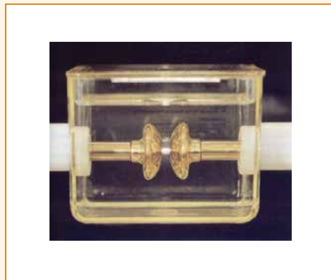
Figura 2 – Cuba de medidor de rigidez dielétrica com eletrodos VDE.
