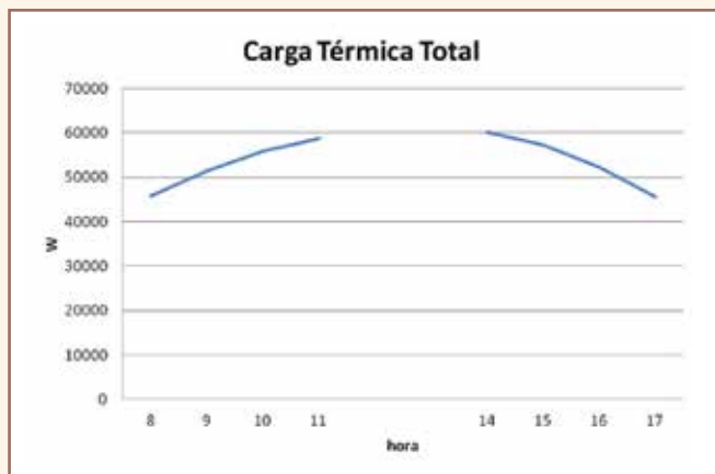
Figura 7 – Perfil de carga térmica do Iteva.
