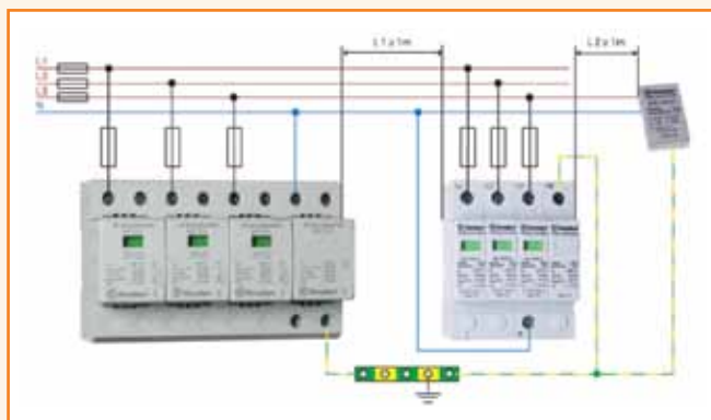
Figura 9 – Coordenação de DPS em uma instalação fotovoltaica. Fonte: Finder.
