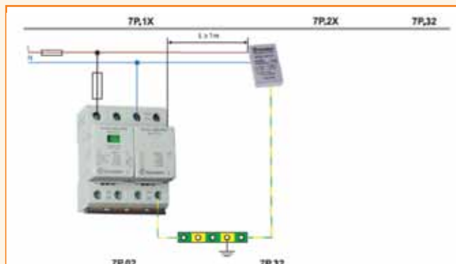
Figura 11 – Coordenação de DPS em uma instalação fotovoltaica.
