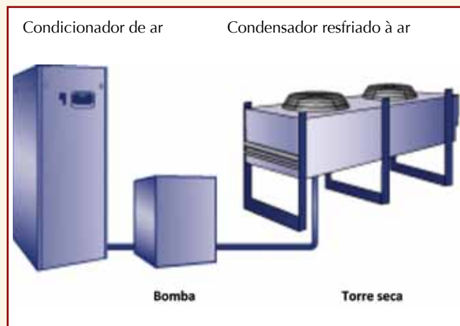
Figura 4 – Sistema de refrigeração a ar.
