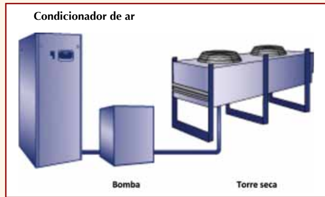
Figura 6 – Sistema de refrigeração com glicol.
