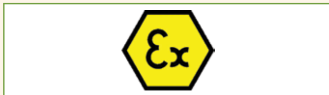
Figura 2 – Símbolo padronizado pela norma DIN 40.012-1/1984 – Protection against explosion: markink of electrical equipment – Signs and Plates para identificação de equipamentos certificados para instalação em áreas classificadas contendo atmosferas explosivas.
