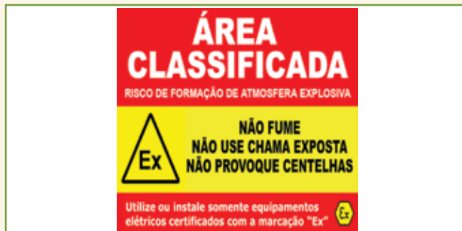
Figura 4 – Placa de sinalização de segurança para a identificação de áreas classificadas contendo atmosferas explosivas de gases inflamáveis ou de poeiras combustíveis.
