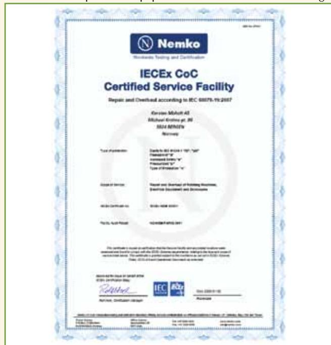
**Figura 1 – Exemplo de certificado de conformidade de oficina de serviços de reparos em motor para área classificada, emitido pelo sistema internacional de certificação IECEx, baseado nos requisitos indicados na ABNT NBR IEC 60079-19. Fonte: Karsten Moholt (Noruega).**
