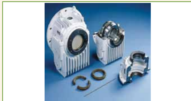
Figura 7 – Partes e peças sobressalentes indicadas na documentação da certificação para reparo em mancal de motor “Ex” com bucha de deslizamento. Este tipo de serviço de reparo atende aos requisitos indicados na certificação de conformidade e na norma do respectivo tipo de proteção “Ex”. (Marcação de serviço de reparo com Letra “R” dentro de um quadrado ).
