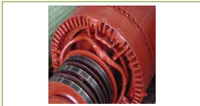
Figura 23 – Reparo de rotor bobinado de motor Ex “d”. Fonte: Petrobras.
