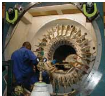
Figura 3 – Execução de serviços de reparos e ensaios elétricos no enrolamento do estator de motor de indução trifásico certificado para atmosferas explosivas em oficina de reparos com certificação de conformidade. Fonte: IECEX System.
