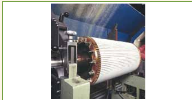
Figura 8 – Serviço de balanceamento dinâmico em rotor de motor de indução trifásico com tipo de proteção Ex “nA”. Fonte: Petrobras.
