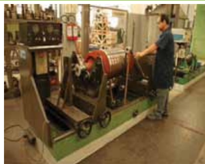
Figura 4 – Serviços de balanceamento dinâmico de rotor de motor de indução trifásico “Ex”. Fonte: Eletro Buscarioli.
