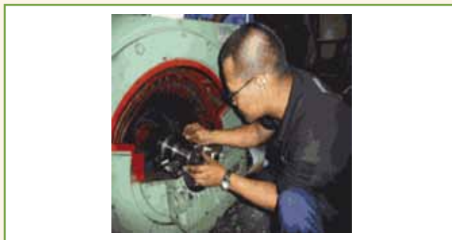
Figura 12 – Execução de serviços de reparos e montagem de mancal do tipo bucha de deslizamento em motor de indução trifásico certificado para atmosferas explosivas, em oficina de reparos certificada. Fonte: IECEx System.
