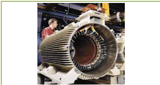
Figura 5 – Serviços de reparo de reenrolamento do estator de motor elétrico Ex “nA” com tensão nominal de 4.16 kV .
