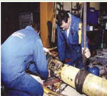
Figura 27 – Serviços de reparo de equipamentos mecânicos com marcação Ex “c”, Ex “b”, Ex “k”, de acordo com requisitos indicados em normas da série ISO/IEC 80079 – Atmosferas explosivas – Equipamentos não elétricos. Fonte: Karsten Moholt (Noruega).
