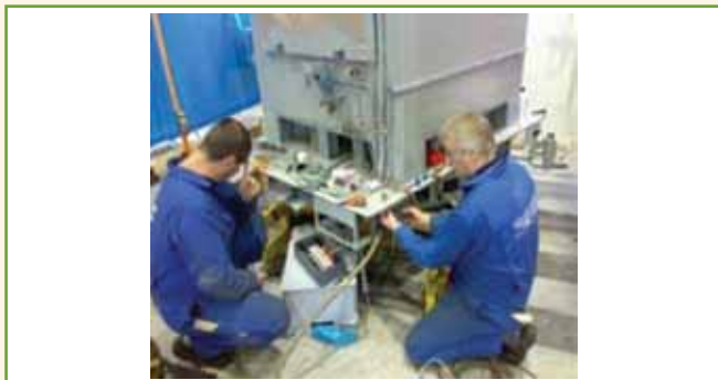
Figura 13 – Execução de serviços de revisão de motor de indução trifásico “Ex” em oficina de reparos com certificação de conformidade. Fonte: IECEx System – Karsten Moholt.
