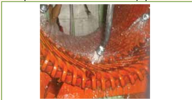
Figura 22 – Execução de ensaio de “spray-test” em estator de motor de 13.8 kV com tipo de proteção Ex “p”, com pulverização de água com detergente neutro, por 30 min, durante serviços de reparo. Fonte: Petrobras.
