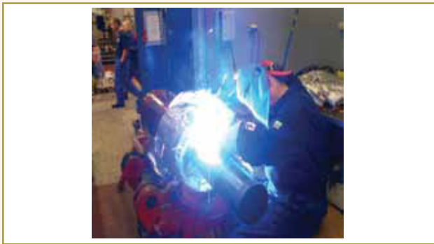
Figura 13 – Exemplo de serviços de soldagem para o fechamento da gaiola de esquilo durante serviços de reparo de motores “Ex”, indicados na ABNT NBR IEC 60079-19 (Fonte: Karsten Moholt – Noruega).
