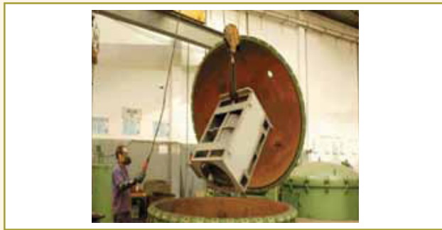
Figura 4 – Processo de imersão de estator de motor de indução trifásico “Ex” em autoclaves de impregnação a vácuo, após serviços de reparo nos enrolamentos do estator (Fonte: Eletro Buscarioli).
