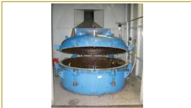
Figura 5 – Autoclave para impregnação a vácuo do tipo Global VPI (Vacuum Process Impregnation) de enrolamentos de motores para serviços de reparos “Ex”.
