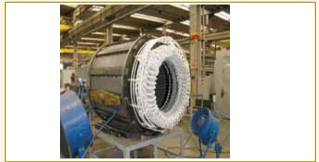
Figura 8 – Serviços de reparos por reenrolamento do estator de motor Ex “p” antes do processo de impregnação a vácuo (Fonte: Petrobras).
