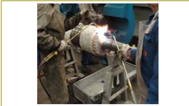
Figura 12 – Serviço de soldagem em rotor de motor de indução trifásico Ex “nA”, 800 kW/4,0 kV para o fechamento da gaiola de esquilo (Fonte: Petrobras).
