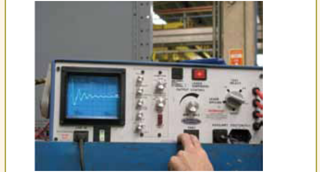
Figura 11 – Medição do ensaio de tensão aplicada (“Surge Test”) após serviços de reparo em motor Ex “p” (Fonte: Petrobras).
