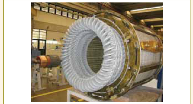
Figura 9 – Serviços de reparo por reenrolamento do estator de motor Ex “p” após o processo de impregnação a vácuo (Fonte: Petrobras).
