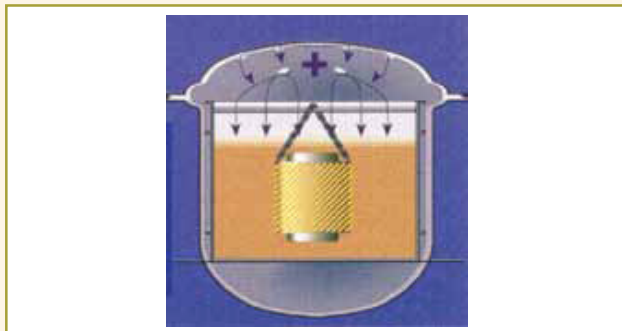
Figura 7 – Sistema de impregnação a vácuo em autoclave do tipo Global VPI (Vacuum Process Impregnation) – Segunda etapa: pressurização para impregnação completa dos enrolamentos e bobina pelo verniz isolante.
