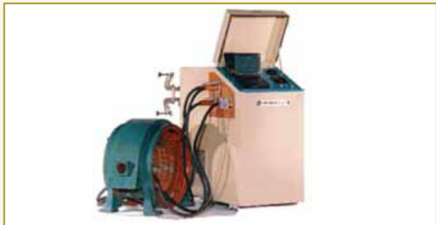
Figura 14 – Ensaio de fluxo requerido na norma ABNT NBR IEC 60079-19 para a detecção de defeitos no isolamento interlaminar do pacote magnético das chapas do estator em motores elétricos “Ex” (Fonte: LEXSECO).
