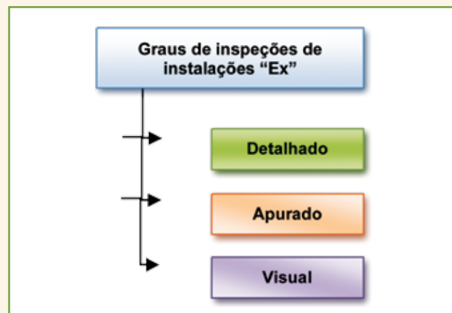
Figura 2 – Graus de inspeções de instalações elétricas e de instrumentação "Ex".
