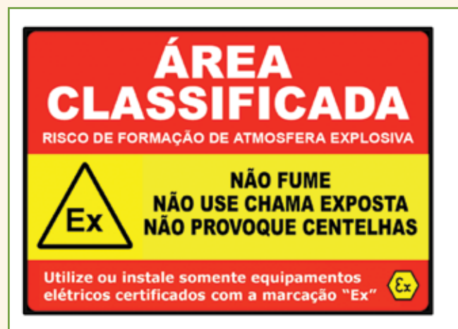
Exemplo de placa de sinalização de segurança para a identificação de áreas classificadas contendo atmosferas explosivas de gases inflamáveis ou de poeiras combustíveis
