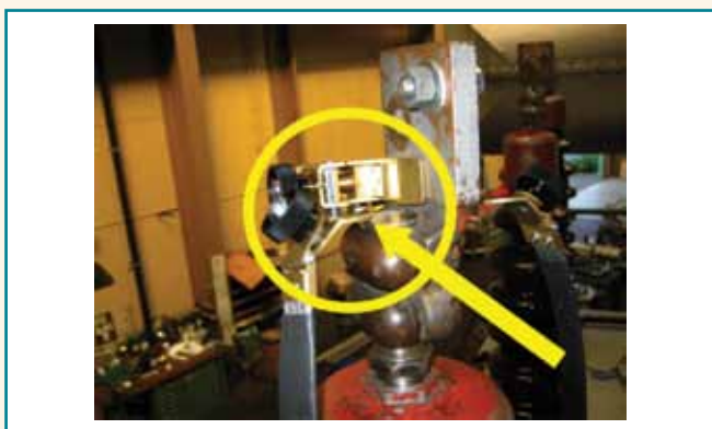
Figura 27 – Ponto de curto-circuito do sinal de medida, referente à Figura 26
