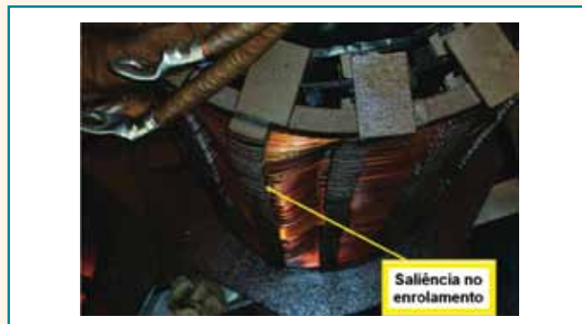
Figura 4 – Defeito em enrolamentos de transformador
