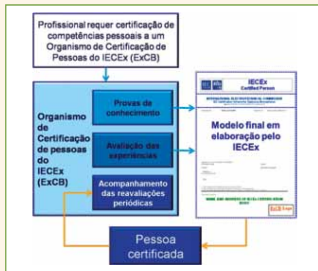
Fluxograma do processo IECEx para a Certificação de Competências Pessoais “Ex”, de acordo com os requisitos da ABNT NBR ISO IEC 17024 e dos Requisitos Operacionais do IECEx
