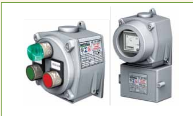
Instrumentos de medição, sinalização e comando, certificados para instalação em áreas classificadas contendo atmosferas explosivas, com invólucros metálicos do tipo à prova de explosão (Ex "d"), com tampa do tipo aparafusada.
