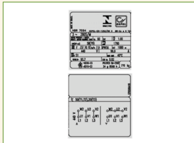
Figura 2 - Exemplo de placa de dados de um motor com tipo de proteção “e”, contendo a marcação referente ao tipo de proteção “e”
