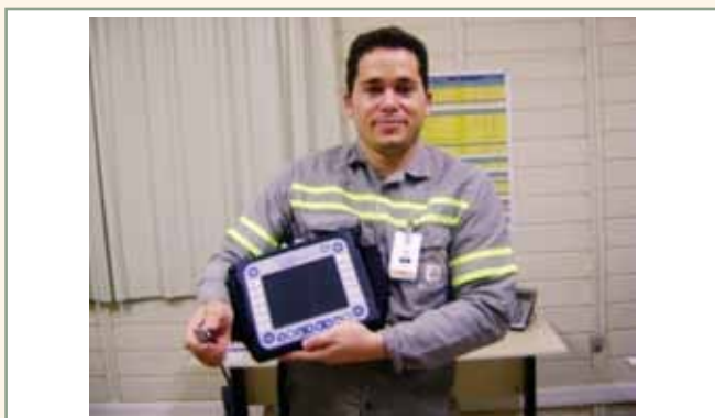
Figura 3 – Equipamento de vibração portátil utilizado por uma equipe de manutenção preditiva
