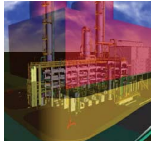
Estudo de classificação de áreas em CAD 3D com regiões classificadas ao redor das fontes de risco do processo e determinação de banco de dados sobre características pontuais de zona, grupo, classe de temperatura e de EPL requerido para cada local
