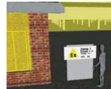
Placa de sinalização de área classificada contendo atmosfera explosiva de gás, com indicação de zona 1, grupo, classe de temperatura e EPL Gb requerido para os equipamentos elétricos e de instrumentação a serem instalados neste local
